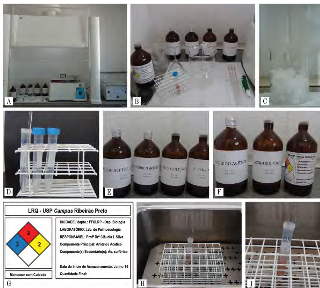
Figura 2- Preparação do material antes da acetólise do pólen. A: Capela de exaustão, contendo no seu interior o banho-maria. B: reagentes e vidrarias usadas no processo da acetólise. C: Becker contendo gelo e um balão com um bastão de vidro no seu interior. D: grade de metal revestida de PVC para colocar os tubos do tipo Falcon com as amostras. E: Reagentes usados no processo de acetólise. F: Frascos identificados, sendo o da direita preparado cuidadosamente para o descarte da mistura de acetólise. G: Modelo da etiqueta para identificação do material químico para tratamento no setor de química responsável na Instituição. H-I: amostra no banho-maria.
